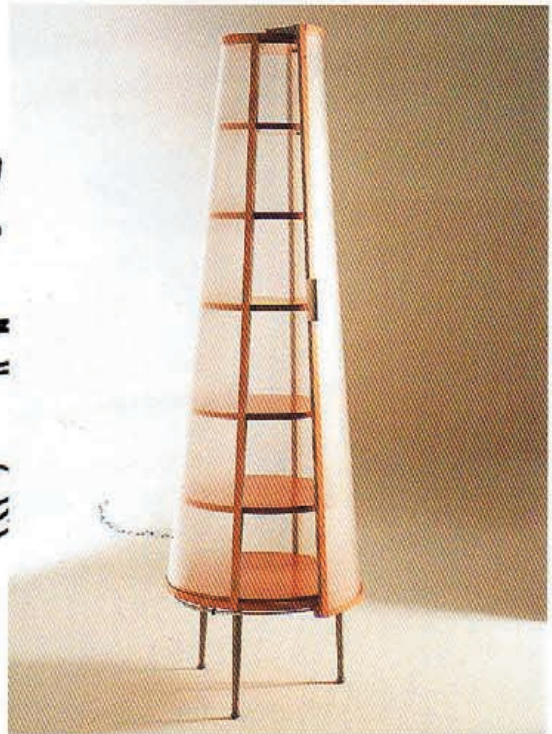
KASUMI (1994) BERNINI 【かすみ】 食器櫃“KASUMI”は、合理的に規格化された洋食器に合わせて網の寸法が決められ、そのため円錐台形のストラクチャーを持つ。曲面にはフレキシブルなポリカーボネートフィルムを使用し、製造上の簡略化と同時に視覚的な軽快感を持たせている。 photo: David Zanardi
